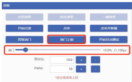
图5-5-1 油门解锁，拖动油门
