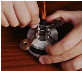
图5-1-1 电机安装
