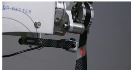
图 6-2-4 光电传感器光束对准反光贴纸
