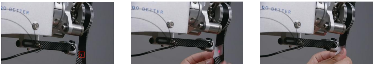
图 6-2-1 螺旋桨张贴反光贴纸
