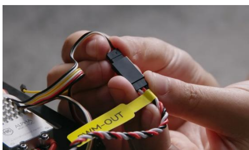
图5-2-3 电调信号线与PWM Out进行连接
