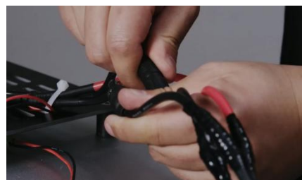
图 4-5-4 更换电机三相线中任意两项
