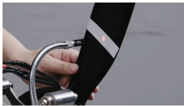
图 5-2-1 螺旋桨张贴反光贴纸
