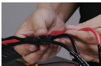
图4-2-1 电调安装及换相转速连接线连接
