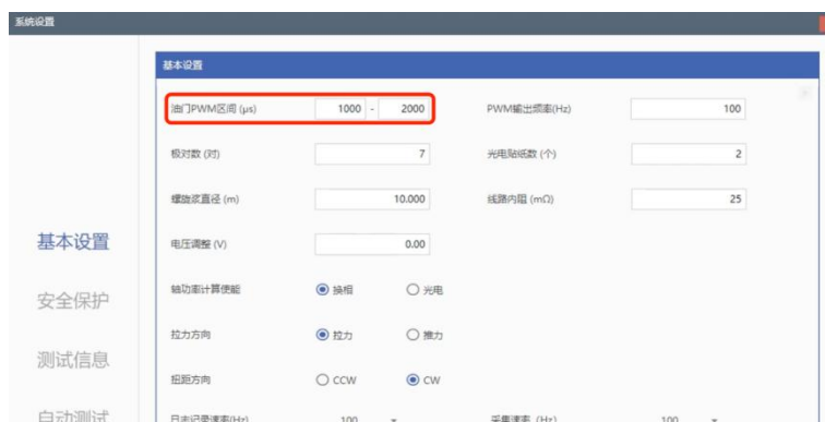
图4-4-1 油门PWM区间设置
