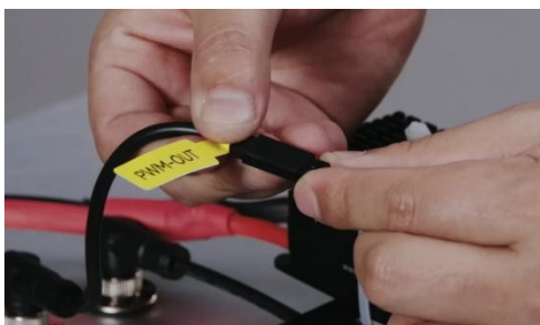
图4-2-3 电调信号线与PWM Out进行连接
