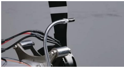
图5-2-2 光电传感器光束对准空气
