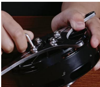
图4-1-1 电机安装
