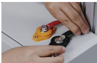
图4-2-2 电调电源输入线与电箱连接
