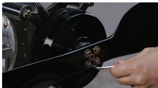
图4-6-1 螺旋桨安装
