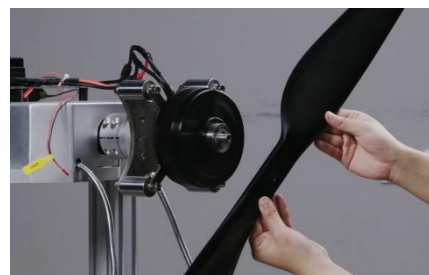
图4-5-2查看电机转向是否正确
