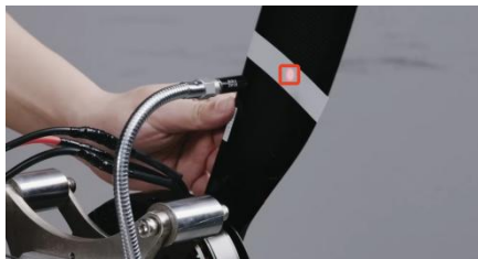
图 5-2-4 光电传感器光束对准反光贴纸
